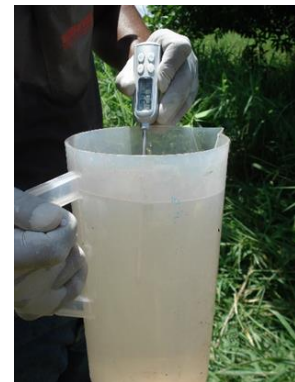
Figura 51. Termômetro Digital – Verificação de Temperatura (°C) no local Fonte: Labsam, 2013
