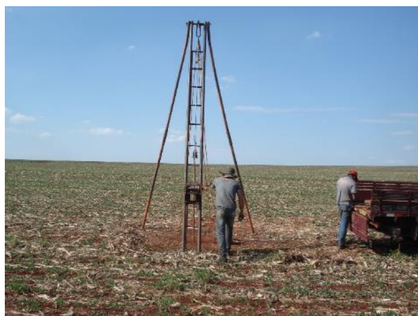
Figura 47. Sondagem SPT na área de implantação do aterro Classe I e ampliação do aterro Classe II CRTR Ambiental Sul
