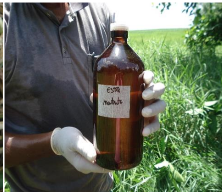
Figura 50. Coleta realizada em frasco âmbar para ensaio físico-químico de Óleos e Graxas Fonte: Labsam, 2013
